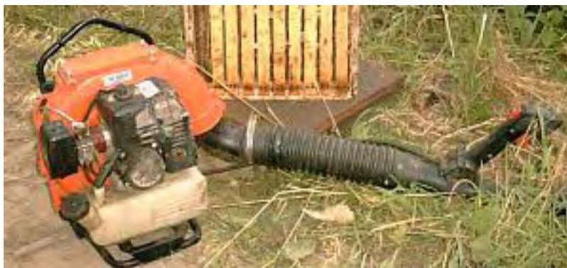
FIGURA 5 - Equipamento para produção de um jacto de ar ou soprador.
